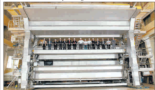
Riesen-Teil: Welch gewaltiges Ausmaß die Papiermaschine hat, lässt diese Aufnahme der Presspartie erahnen. Gebaut wurde die Maschine vom finnischen Unternehmen Metsäpaper. Dessen Mitarbeiter und Vertreter der Progroup AG sind bei der Abnahme der beiden Hauptmodule vor wenigen Wochen in die Partie gestiegen. Foto: Metsäpaper
